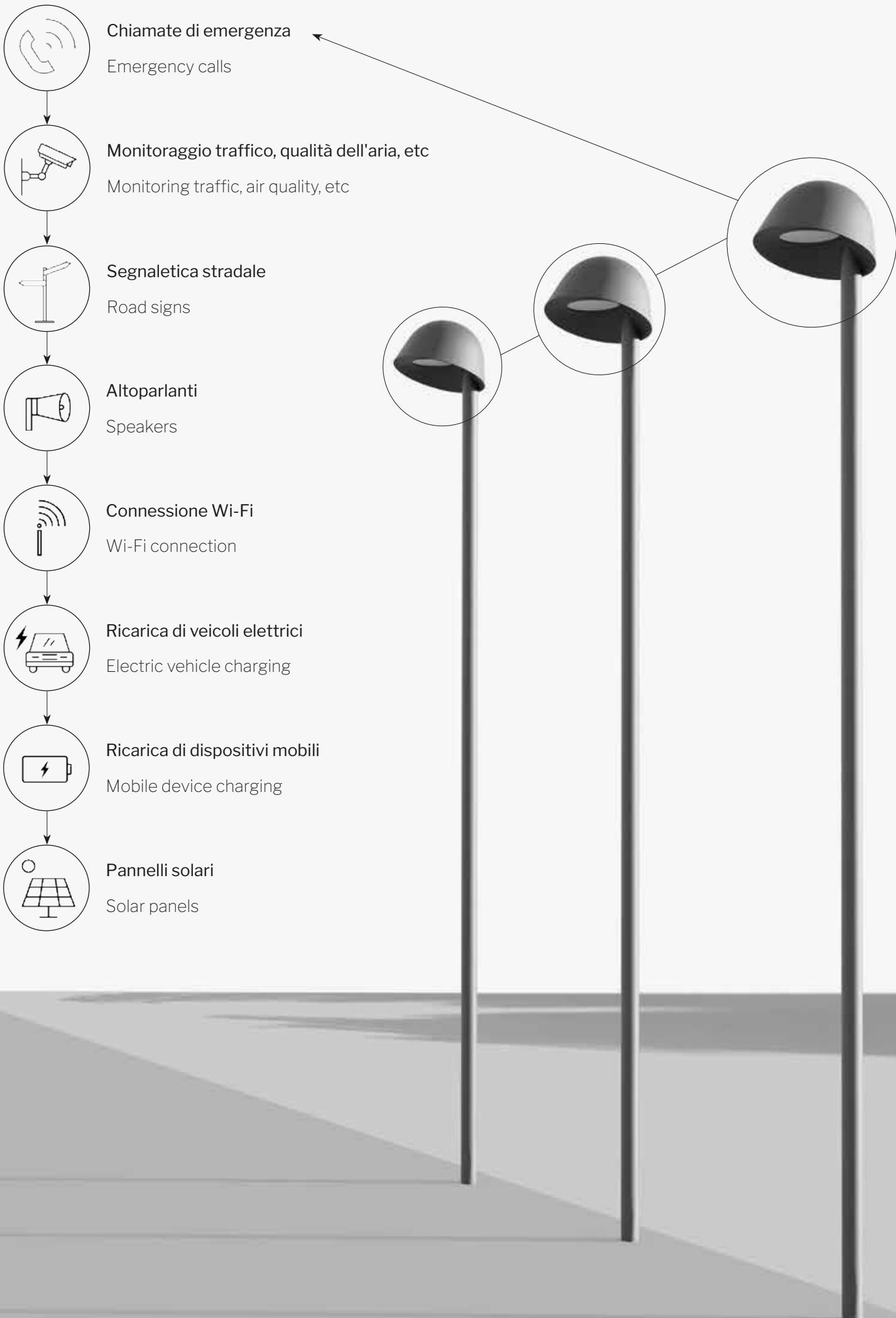
Il lampione da elettrico diventa elettronico ed interconnesso, garanzia di vantaggi tipici di una Smart City: dalla riduzione dei consumi elettrici all'erogazione di servizi utili per il cittadino (ad esempio videosorveglianza, controllo del percorso dei mezzi pubblici o misurazione delle polveri sottili). Inoltre, il materiale polimerico delle lampade Lorelux® non scherma le onde radio e consente di eliminare le antenne esterne mantenendo inalterata l'estetica dell'apparecchio illuminante.
