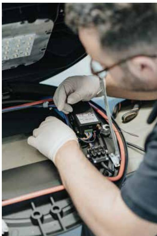
A sinistra e in basso a destra, alcune fasi del processo di assemblaggio della componentistica elettronica al corpo del lampione. In alto a destra, il controllo qualità del prodotto.
